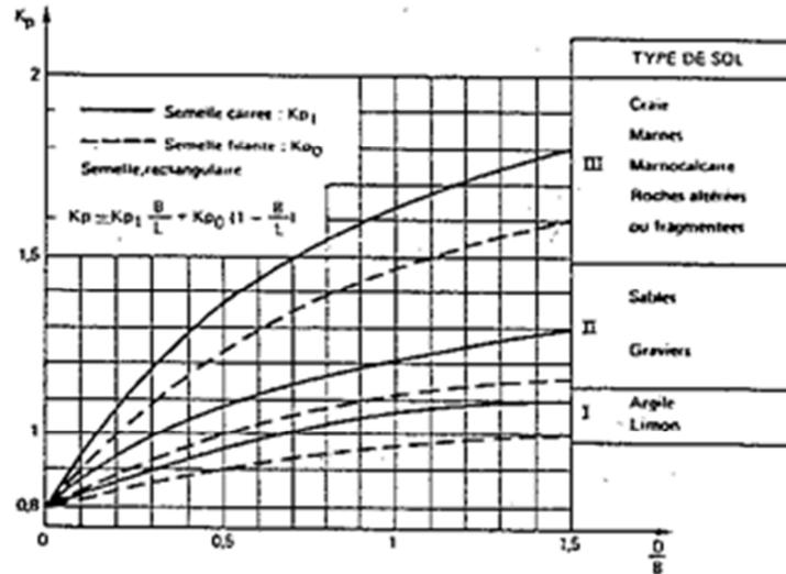
Le coefficient minorateur  $i_s$  est déterminé par l'abaque suivant :
