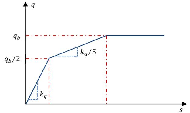
Evaluation de la rigidité axiale d'un pieu à partir de la loi de mobilisation du frottement axial
