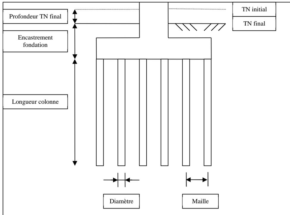
Cocher la case « Variation en fonction de la profondeur » provoque l'apparition d'une boîte de dialogue, où l'utilisateur doit saisir le diamètre de la colonne aux différentes profondeurs définies dans les essais pressiométriques (d'où l'importance de saisir le sondage avant les données concernant les colonnes ballastées).
